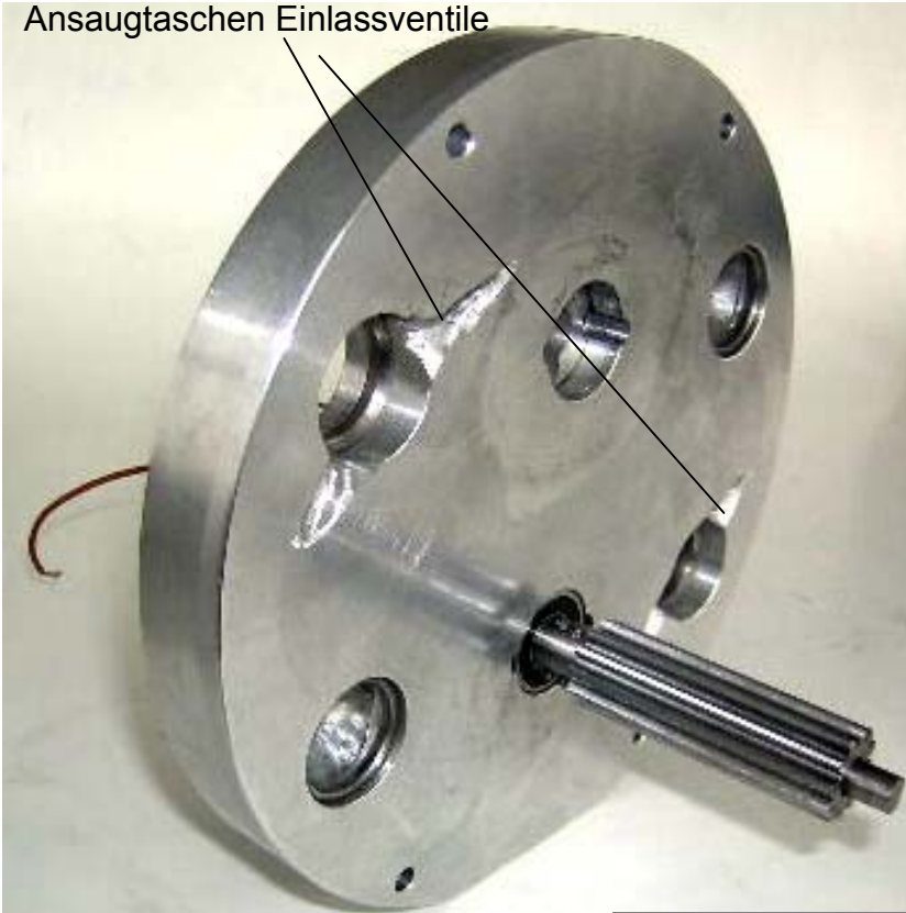
Grundplatte mit einer on zwei Ritzelwellen montiert
