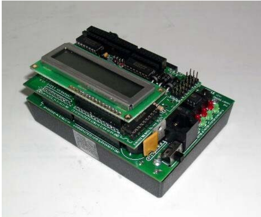
Steuer- und Programmiergerät D-RAM Baustein und alpha-numerischem Display
